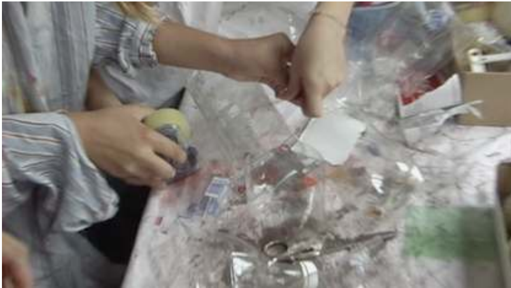
Die zylindrischen Teile der PET-Flaschen werden zusammengeklebt.
